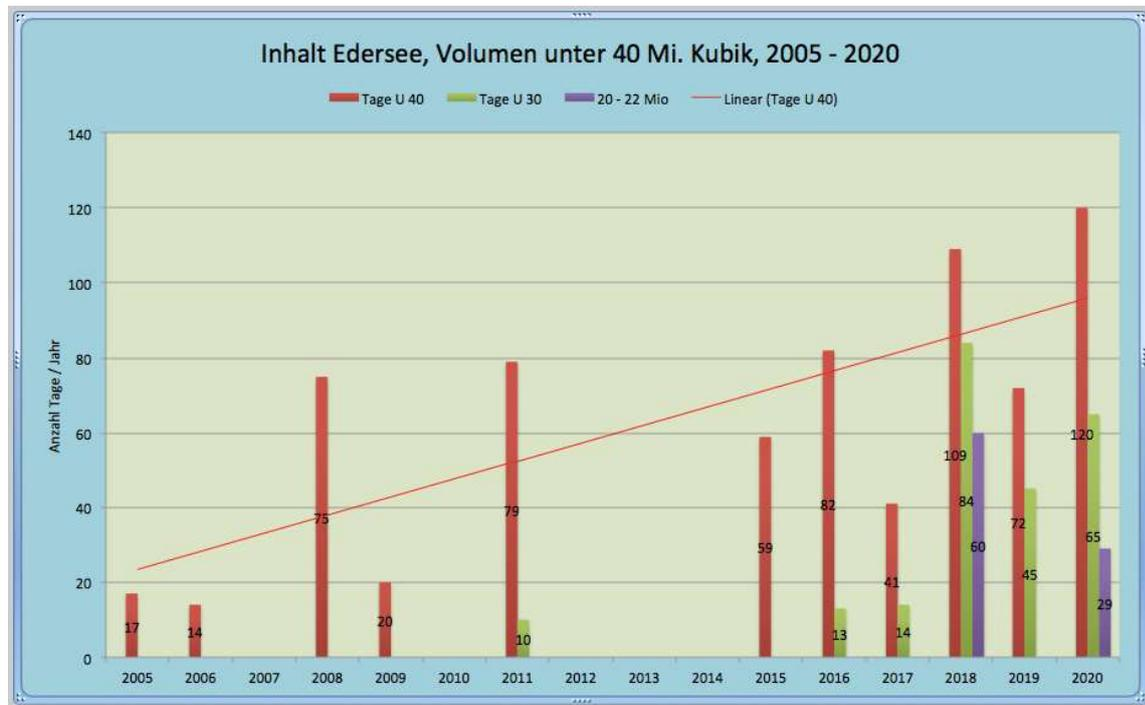
**Bild 16:** Gezeigt wird die Anzahl der Tage pro Jahr, in denen der Wasserstand im Edersee auf unter 40 Mio. Kubikmeter absinkt.
